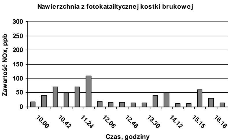
Rys. 6. Pomiary koncentracji tlenków azotu NO x w powietrzu – porównanie nawierzchni asfaltowej i nawierzchni z fotokatalitycznej kostki brukowej [8]
